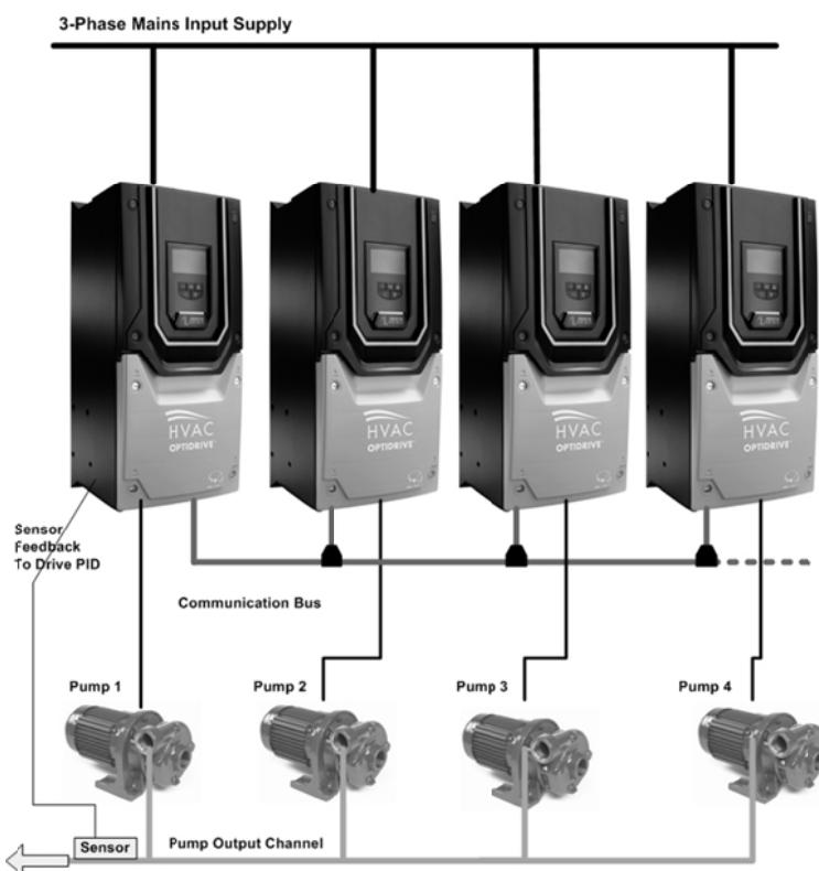
Привода подключаются с помощью кабеля (витая пара, с разъемами RJ45) по протоколу RS485 с применением сплиттеров, максимально можно подключить до 5 приводов . Заказные номера:
