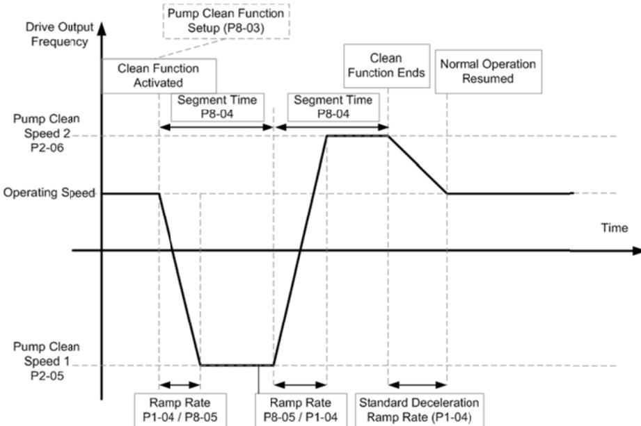
После завершения функции очистки насоса привод немедленно возвращается к заданной текущей скорости. Возвращение к нормальной скорости выполняется с использованием параметров стандартного ramp (P1-03 / P1-04). Время выполнения этапа (задается в P8-04) охватывает время разгона скорости двигателя для очистки, но не включает ступенчатого возвращения к нормальной скорости.
