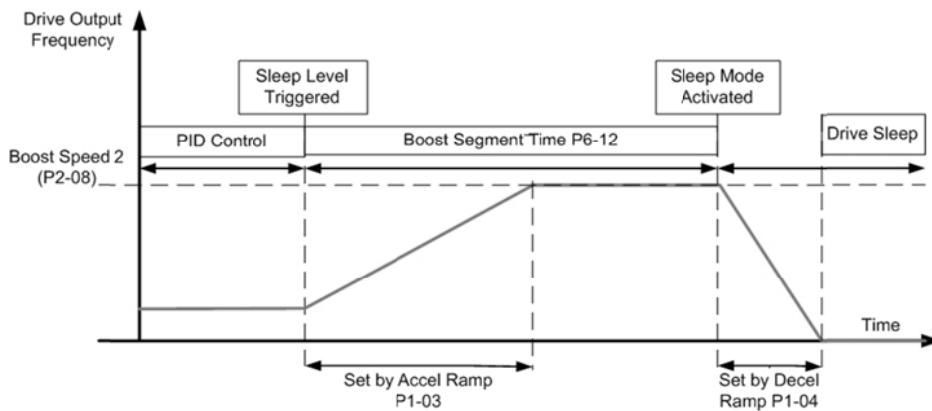
Время выполнения для обоих сон и функции усиления следа (P6-11 и P6-12) включает время, потраченное, чтобы ускориться к скорости усиления (P2-07 и P2-08), но не время, чтобы ускориться или замедлиться функции усиления. Это показывают в схемах синхронизации.
