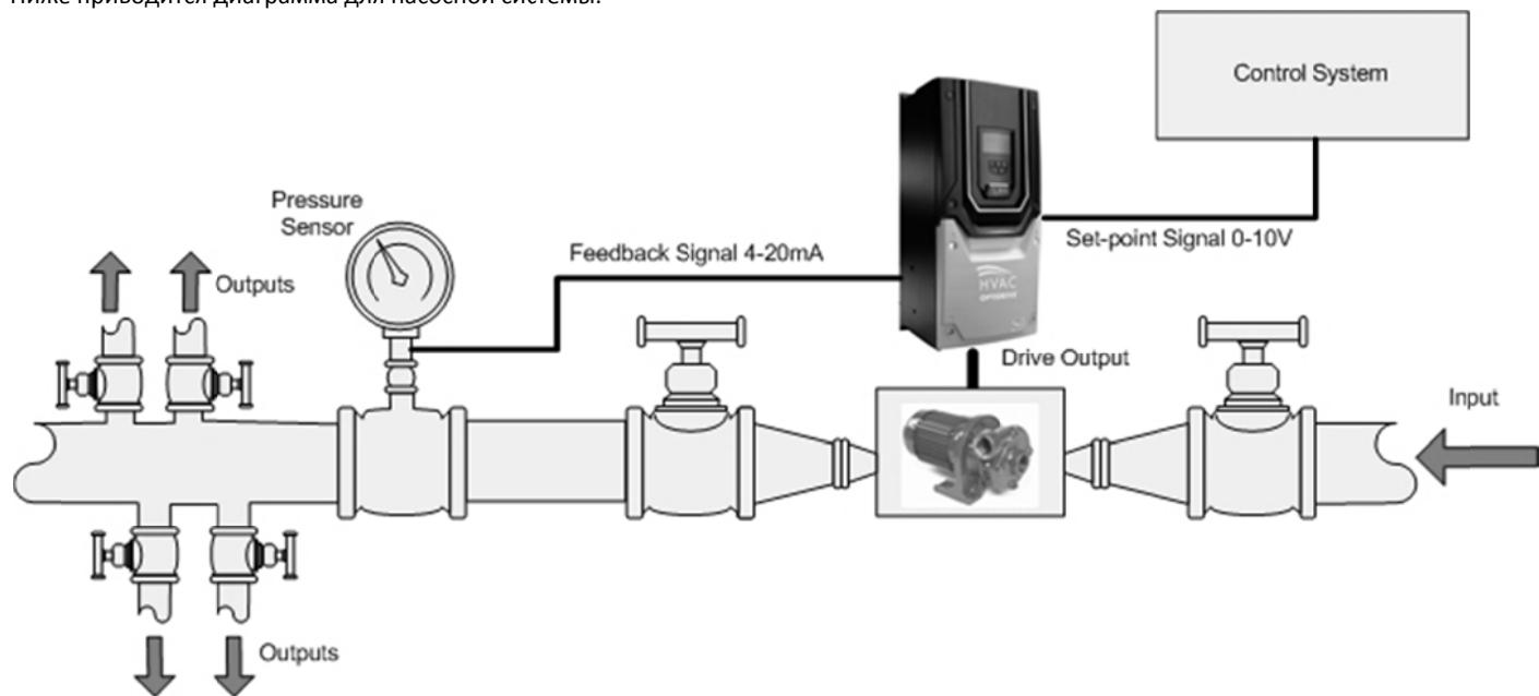
Optidrive HVAC должен поддерживать давление при выводе насоса к установленному значению и поддерживать это заданное значение, поскольку различные выходные значения открываются и закрываются.
