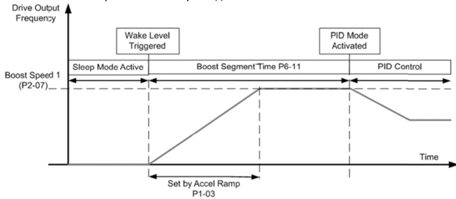
Усиление сна насоса включается, когда время задержки скорости над отключением P6-12 устанавливается в значение кроме 0. P6-12 содержит время, когда привод выполнит функцию усиления прежде, чем ввести режим ожидания. Скорость для функции усиления на сне устанавливается в предварительно установленной скорости 8 (P2-08). Схема синхронизации ниже дает пример установки и профиля движения для функции усиления при режиме сна.
