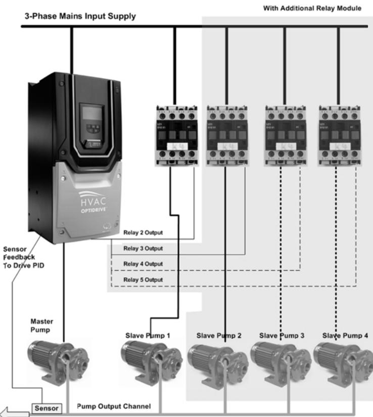
Реле 1 на терминале стандартных I/O привода (T14 и T15) не может использоваться как часть элемента управления DOL, но является свободно программируемым для других функций через параметр P2-15. Реле 2 на стандартном терминале I/O привода (T17 и T18), может использоваться, как элемент DOL, для первого дополнительного насоса. Реле 2 задается для управления DOL параметром установки P2-18 = 8, или может использоваться для альтернативной функции, установив значение, отличное от 8.
